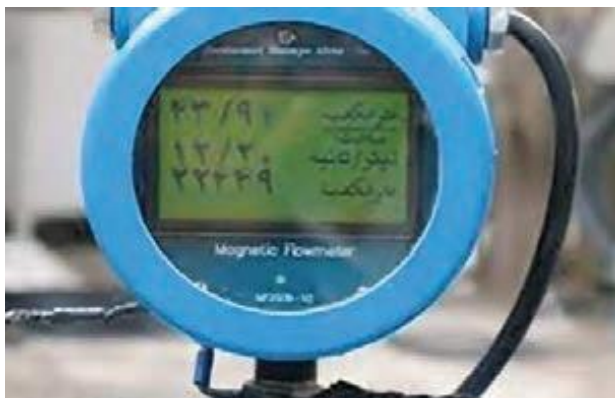
شکل ۴ - کنتورهای هوشمند، راهی برای اندازه‌گیری و کنترل برداشت از چاه‌ها
